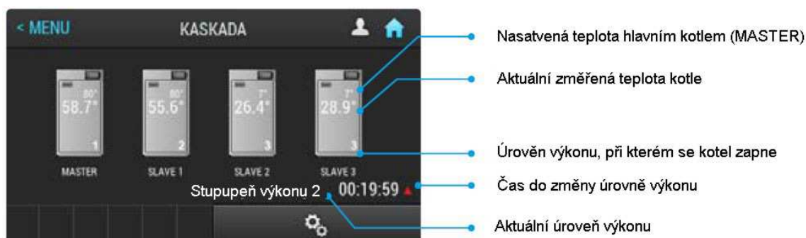
Obr. č. 16 – zapojení kotlů do kaskády
